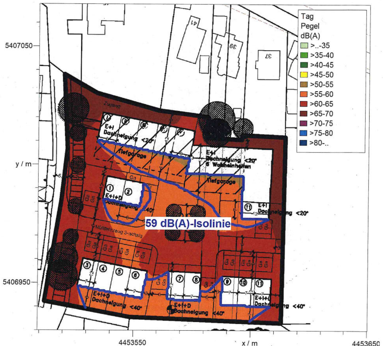
Abbildung 2: Immissionspegelraster mit Beurteilungspegel Tagzeitraum
