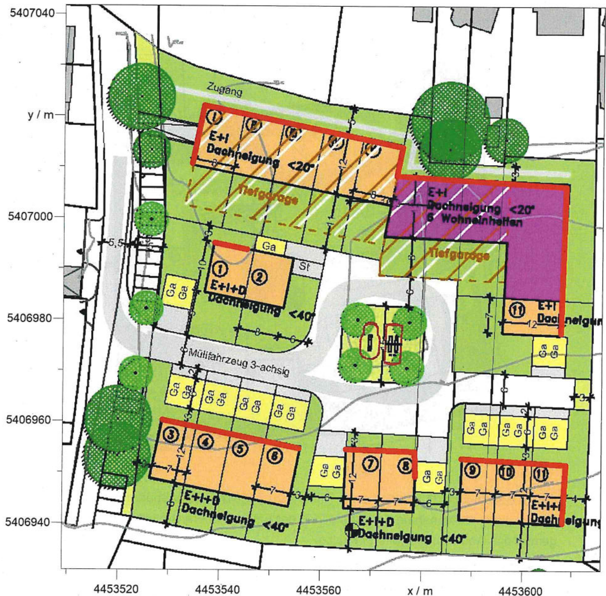
Abbildung 4: Darstellung der Fassadenbereiche mit Nachtpegeln \geq 60 dB(A)
